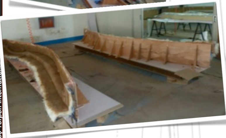
Plugs and molds of beams structure Préforme et moules de carénage de bras
